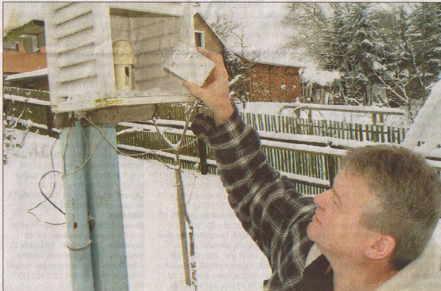
Zu Frank Löschers Wetterstation gehört auch ein kleines Wetterhäuschen. Dort werden Temperatur, Luftdruck und Luftfeuchte erfasst.
